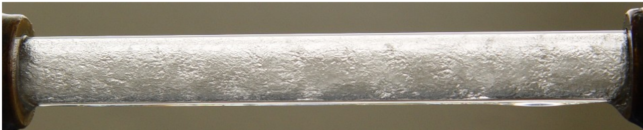
Figura 9. Registro fotográfico do padrão anular de escoamento.
