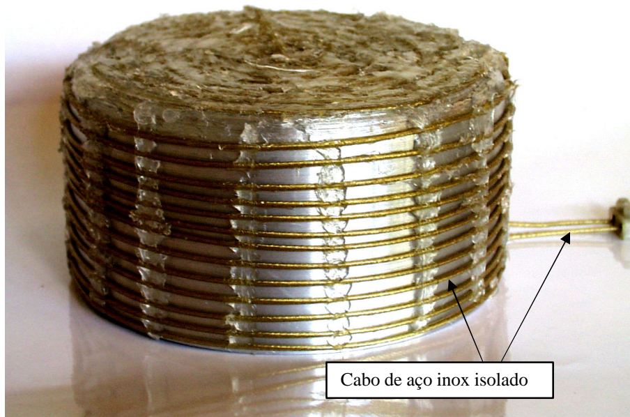
Figura 1. Blindagem térmica montada com panela de alumínio e cabo de aço inox para varal.
