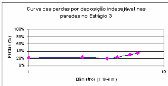
Figura 16 – Curva de perdas por deposição indesejável nas paredes no Estágio 3
