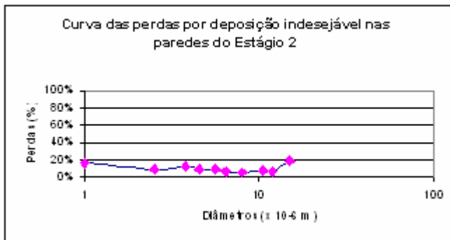
Figura 15 – Curva de perdas por deposição indesejável nas paredes no Estágio 2
