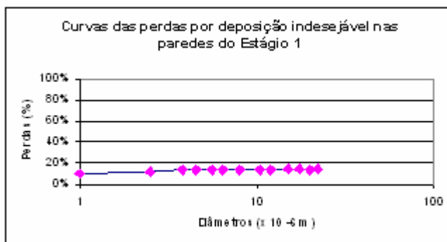
Figura 14 – Curva de perdas por deposição indesejável nas paredes do Estágio 1
