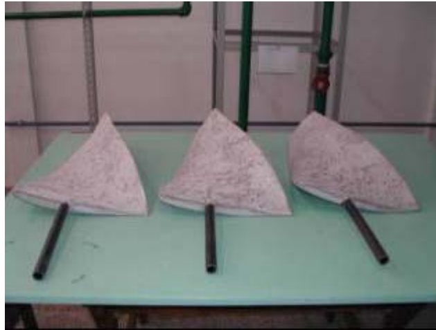
Figura 8. Pás do rotor da turbina em fibra de vidro com resina poliéster.
