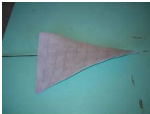
Figura 7. Molde da pá do rotor da turbina.
