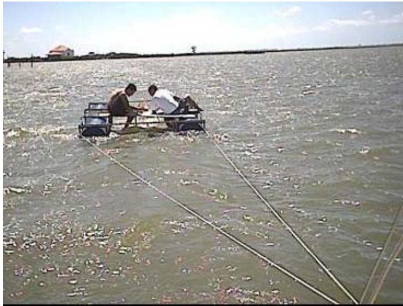
Figura 12. Turbina sendo rebocada pelo barco e medições de torque e rotação.
