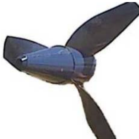
Figura 9. Rotor da turbina montado.
