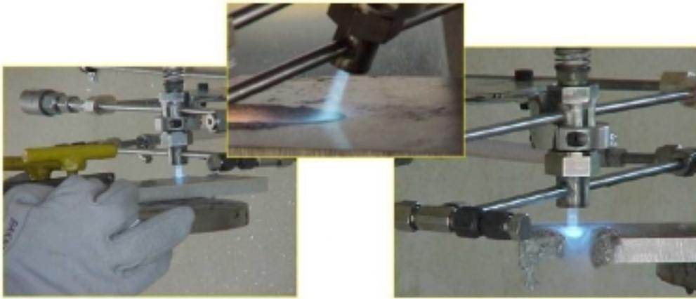
Figura 6. Corte de alumínio utilizando o protótipo de maçarico baseado na tecnologia de propulsão líquida.
