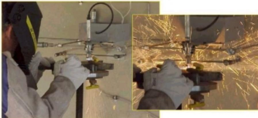
Figura 7. Corte de aço utilizando o protótipo de maçarico baseado na tecnologia de propulsão líquida.
