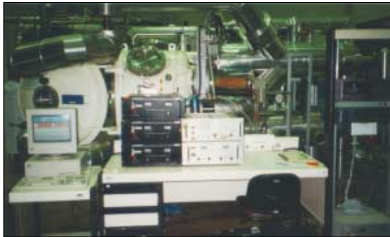
Figura 8. Arranjo Experimental utilizado no LIT para análise das perdas dos radiômetros: CVT de 250 litros, fontes de energia DC e sistema de aquisição de dados.
