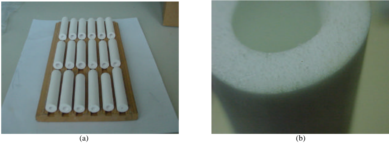
Figura 6. (a) Elementos porosos cerâmicos, (b) detalhe da superfície de uma amostra.
