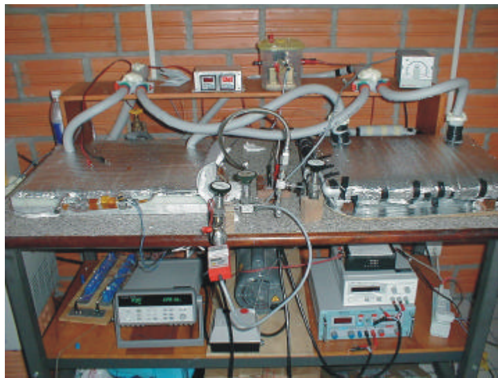
Figura 5. Bancada experimental utilizada para testes do sistema de bombeamento capilar (LabCET/UFSC).
