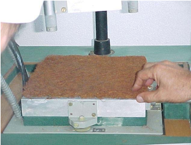
Figura 3 – Instalação do compósito entre as placas quente e fria da mesa de condutividade térmica.
