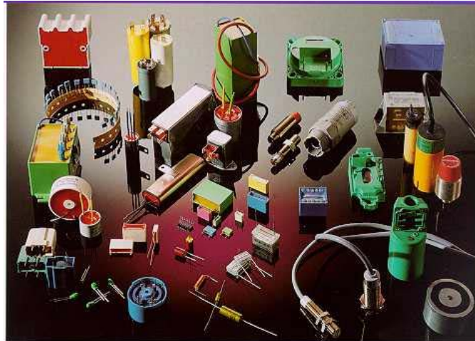
Figura 1. Componentes eletroeletrônicos ativos e passivos encapsulados com a resina Arathane.
