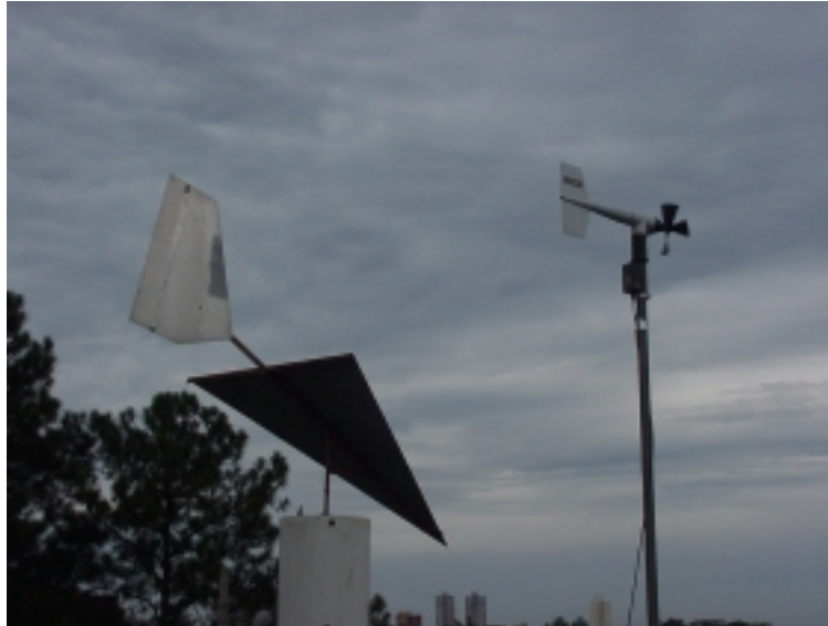
Figura 7: Dispositivo de ventilação natural e anemômetro de vento montados no teto de uma instalação predial.
