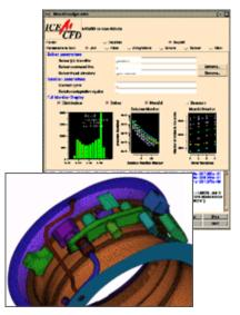
O software ICEM-HEXA pode ser adquirido como pré-processador dos solvers da família CFX, o que gera grandes vantagem: exportação automática da malha gerada pelo ICEM diretamente para o CFX; além de todo suporte para um problema de CFD e redução de custos de aquisição. Como principais características destacamos:
