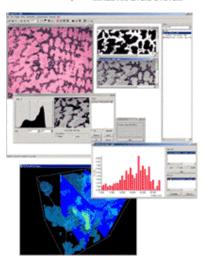
Simulação da condutividade térmica e elétrica, permeabilidade em modelos microestruturais 3D de materiais, tais como sinterizados porosos
