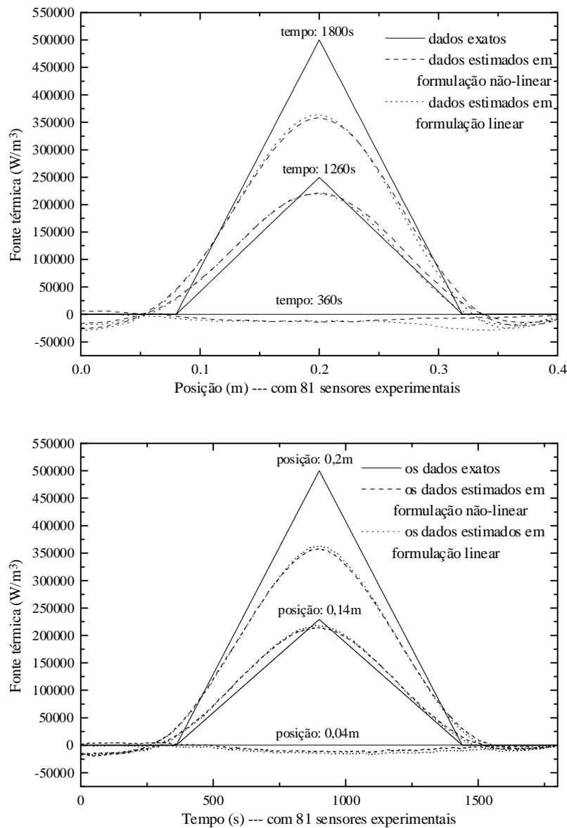
Figura 1 – Estimativas para a fonte térmica com 81 sensores de temperatura.
