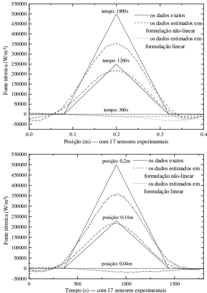
Figura 2 – Estimativa para a fonte térmica com 17 sensores de temperatura .
