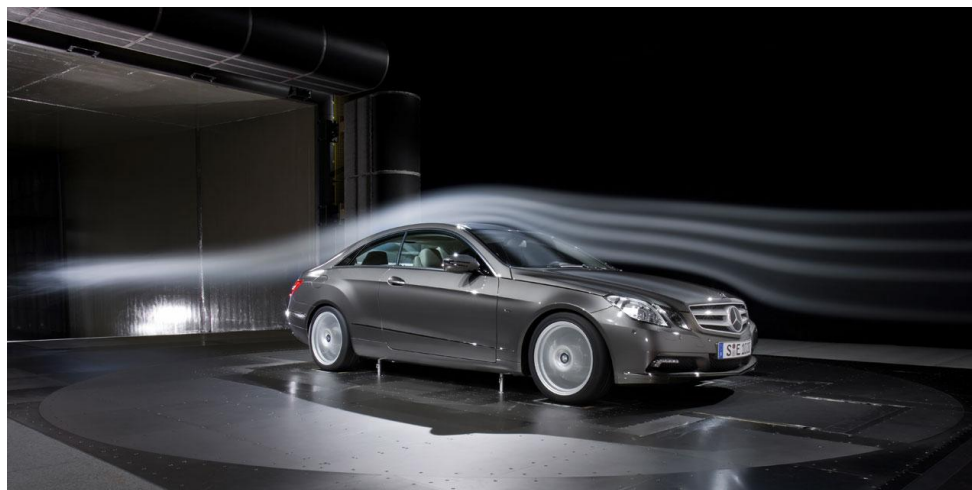
Figura 1 – Ensaio de um modelo automobilístico em um túnel aerodinâmico.
