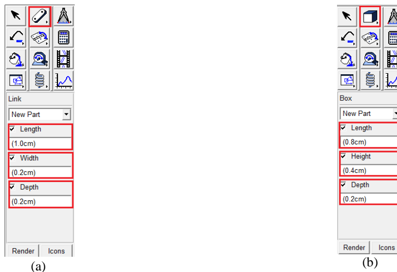
Figura 4 – Caixa de ferramentas utilizada na criação (a) do Link 2 (manivela). (b) do Link 4 (box do slider).
