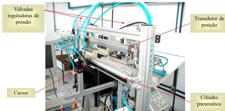
Figura 1 - Sistema pneumático de posicionamento (Cruz, 2003).
