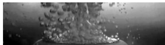
Figura 9. Visualização do fenômeno de ebulição para o caso confinado ( s = 0,1 mm) e para o não confinado.
