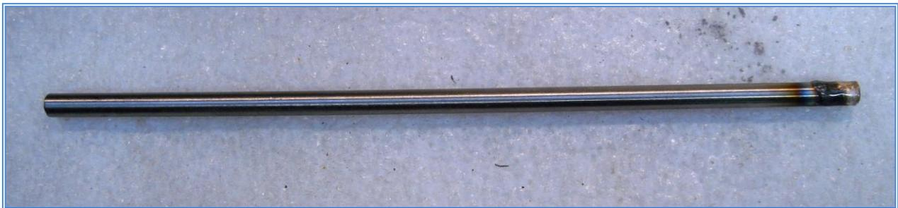
Figura 3 – Tubo de aço inox 316-L (200 mm de comprimento e 4,76 mm de diâmetro externo).
