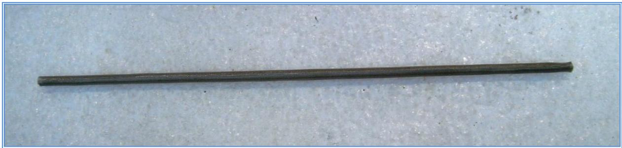
Figura 2 – Tela enrolada (200 mm de comprimento e 21 mm de largura).
