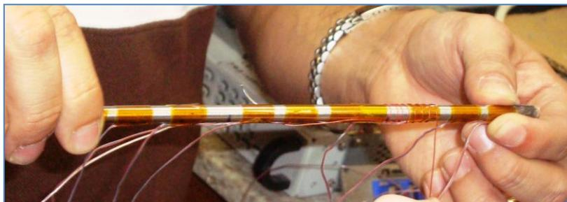
Figura 5 - Tubo de calor, termopares e resistência elétrica (formato de espiral).
