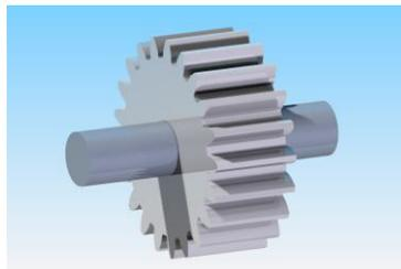
Figura 1 – União eixo-cubo com interferência transversal em uma engrenagem montada à quente no eixo.
