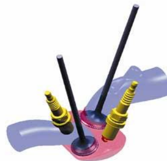
Figura 1. Esquema de uma câmara de combustão com duas velas
