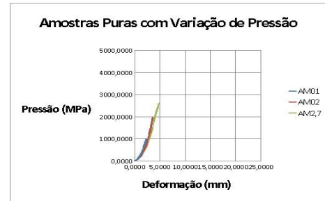
Figura 2. Comportamento das curvas de compactação das amostras em estudo.
