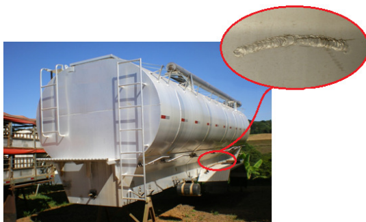
Figura 1. Silo graneleiro com defeitos na base
