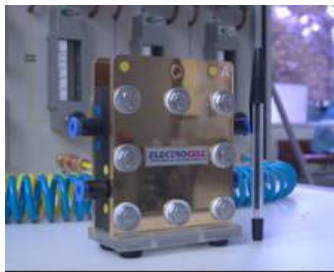
Figura 1 – Célula Combustível PEM 15 W
