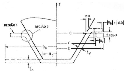
Fig 1 Geometria do processo de repuxamento convencional
