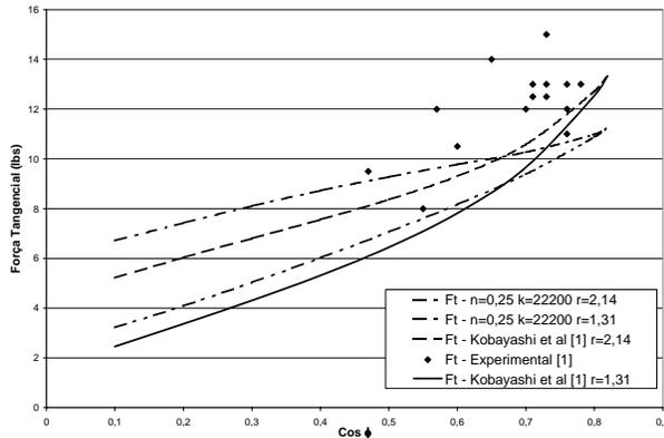
Fig. 2 – Comparação entre os componentes de forças tangenciais teóricas obtidas, e as previstas por Kobayashi et al. e os pontos experimentais [1], para  $t_0=0,05$ in,  $f=0,0281$ ipr,  $a=1,054$  in e  $\alpha=35^\circ$ .
