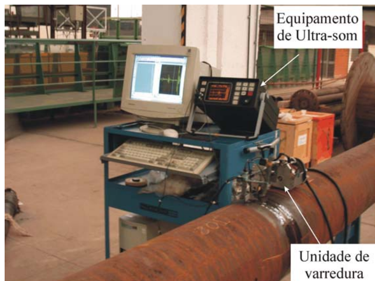
Figura 1. Equipamento utilizado no ensaio TOFD .
