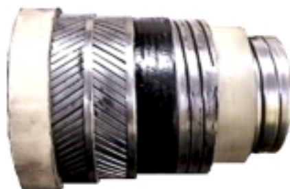
figura 1 – Estrutura típica de uma linha flexível
