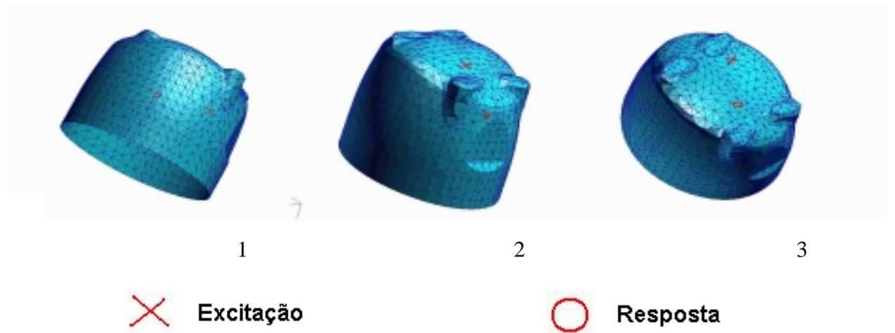
Figura 3 – Posições de fixação do acelerômetro (sinal) e da excitação.
