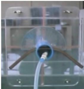
Figura 2. Esquema da tomada de pressão sobre um cilindro
