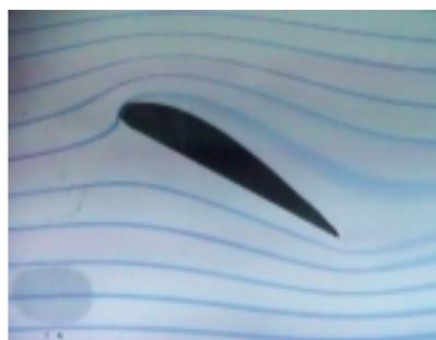
(b) perfil aerodinâmico em canal hidráulico
