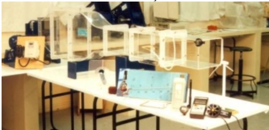
Figura 1. Túnel de vento de pequeno porte construído no LSFM
