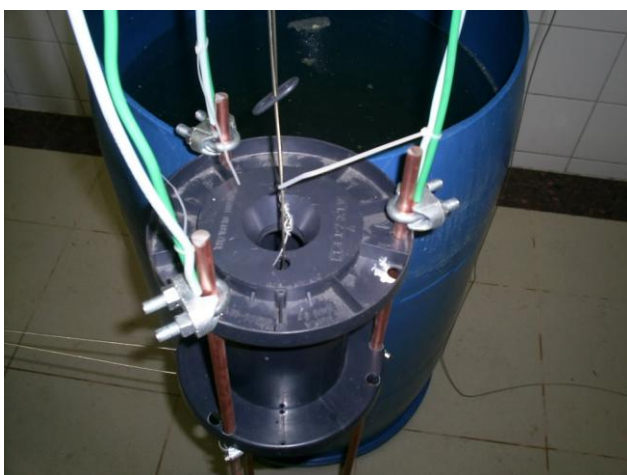
Figura 2 – Carretel e hastes de cobre ligadas as fases
