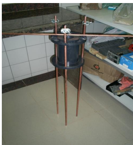
Figura 2 – Carretel e hastes de cobre ligadas as fases
