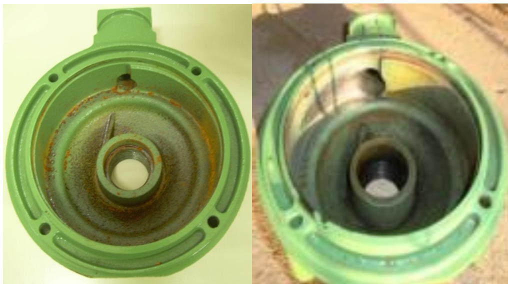
a) b) Figura 6 - Carcaça a) antes da intervenção e b) depois da intervenção.
