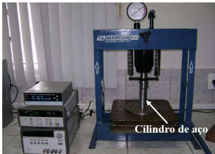
Figura 7. Vista geral do sistema de prensagem uniaxial a quente para fabricação de compósitos.
