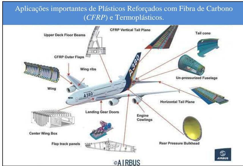
Figura 1. Uso de CFRP em componentes do avião Airbus A380 (Carbonfiber, 2007).
