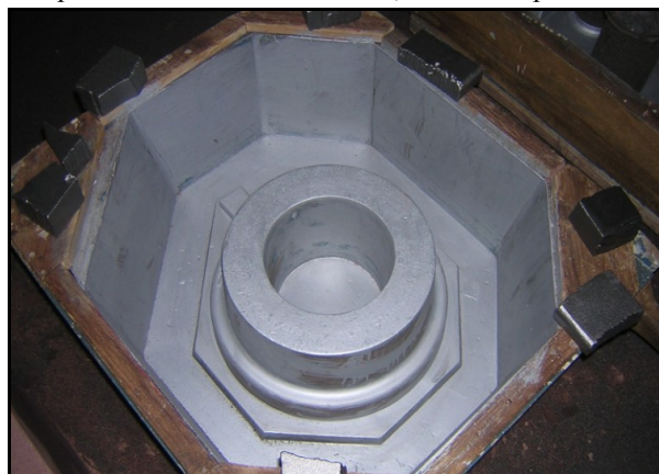
Figura 6. Modelo em caixa-placa.
