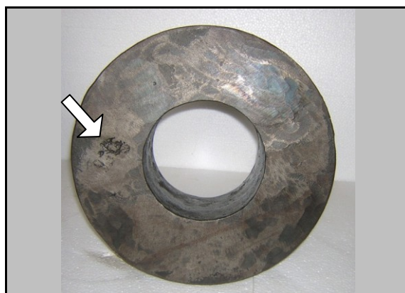
Figura 9. Peça em bruto com descontinuidade visível na região do alimentador.
