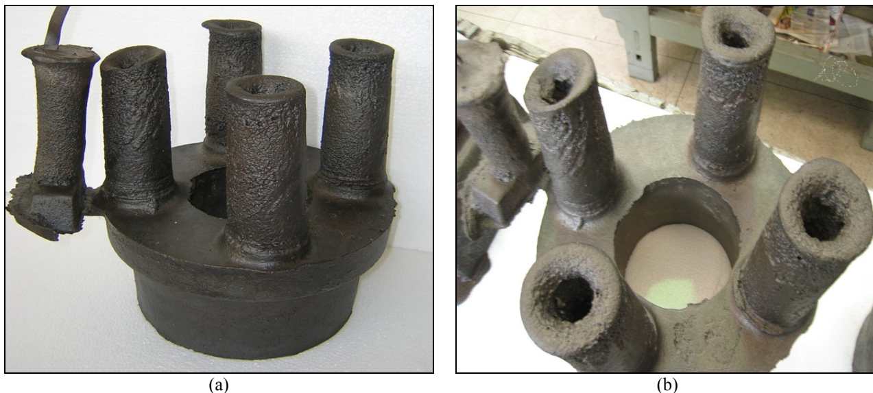
Figura 8. Detalhes da peça fundida com seus alimentadores.
