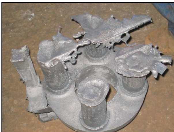
Figura 17. Peça fundida com projeto revisado.
