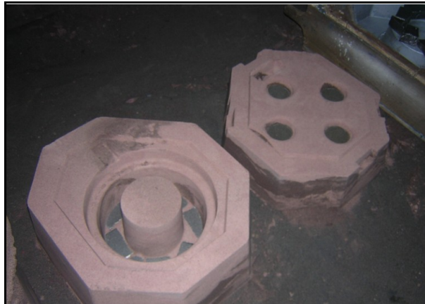
Figura 7. Partes inferior e superior do molde.
