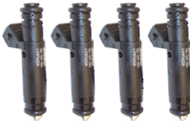
Figura 2. Eletroinjetores Siemens Racing de 60 lb/h. Fonte: Fuel-Tech, 2009.
