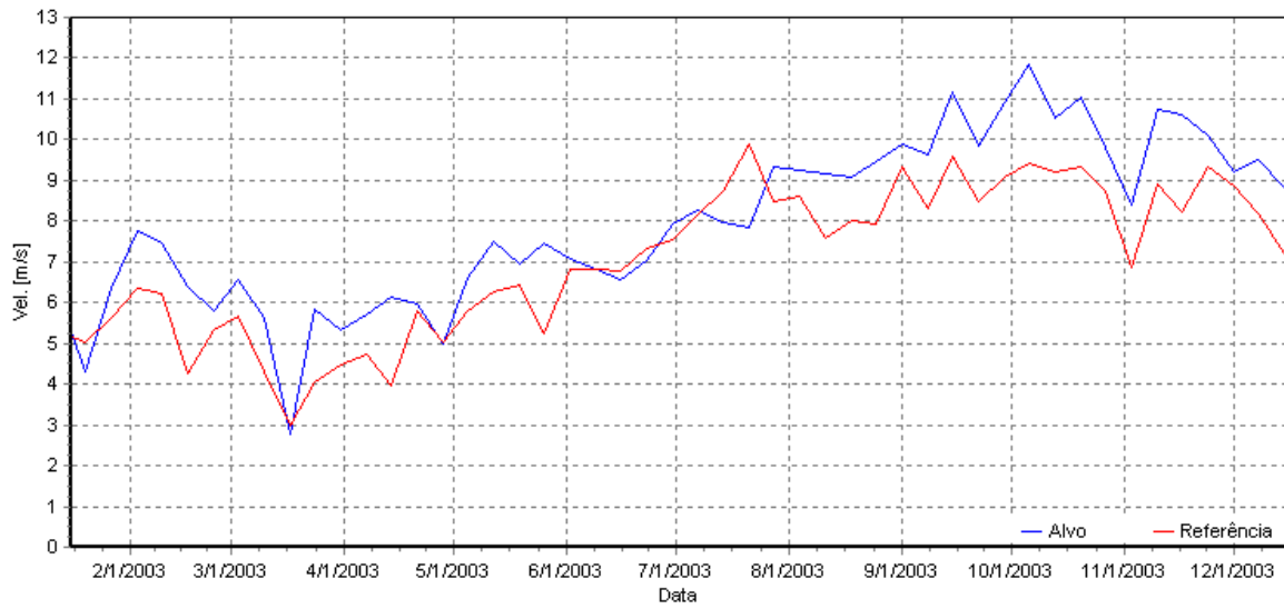
Figura 6. Comparação com médias semanais do período concomitante entre os dados da torre alvo e dados de referência NCAR2.
