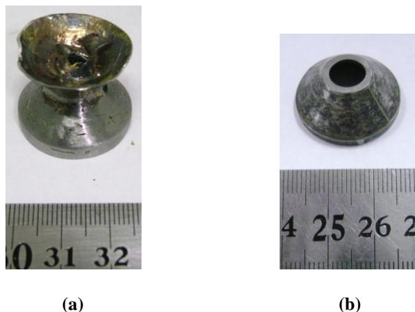
Figura 6. Em (a), produto final inacabado da fusão. Em (b), arruela Belleville da LMF Ni-Ti cortada e acabada.
