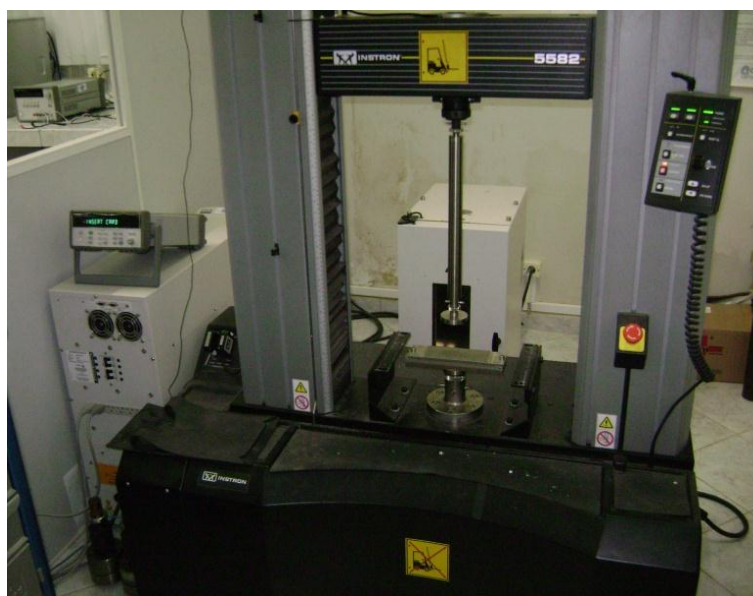
Figura 7. Máquina universal de ensaios Instron 5582 usada nos ensaios de geração de força da arruela Belleville de Ni-Ti.
