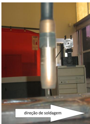
Figura 7. Posicionamento da tocha e suporte do espectrômetro.
