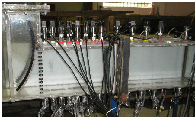
Figura 3. Instalação dos transdutores de pressão no conduto.
