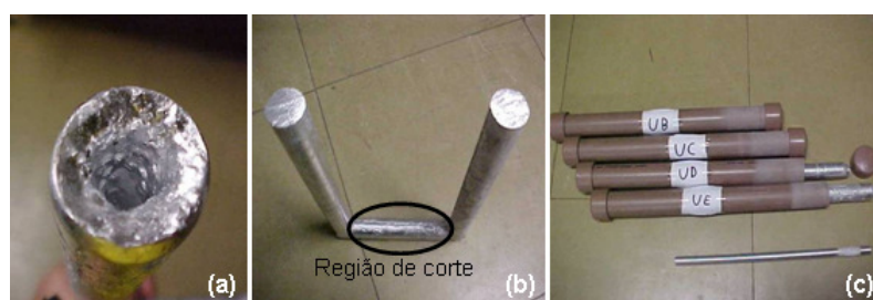
Figura 4. (a) defeito gerado na solidificação, (b) lingote fundido sem os defeitos com identificação da região de corte e (c) as “pernas” do lingote identificadas para usinagem.
