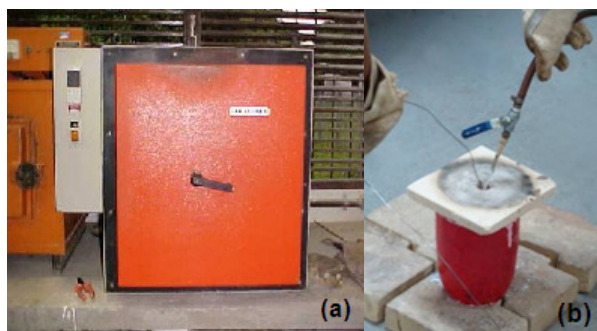
Figura 1. (a) forno utilizado na preparação das ligas e (b) injeção de argônio.
