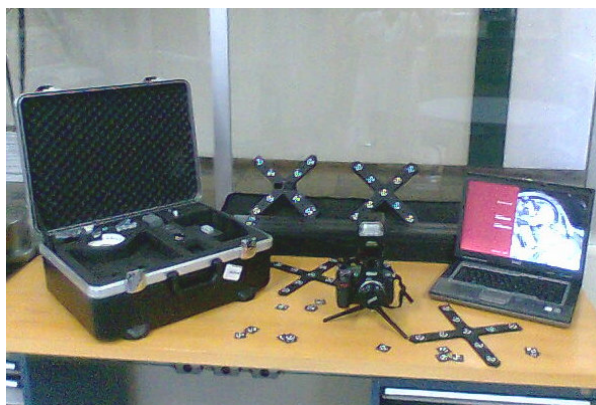
Figura 6. Princípio de medição por Fotogrametria e Sistema de Medição TRITOP (GOM, 2007).
