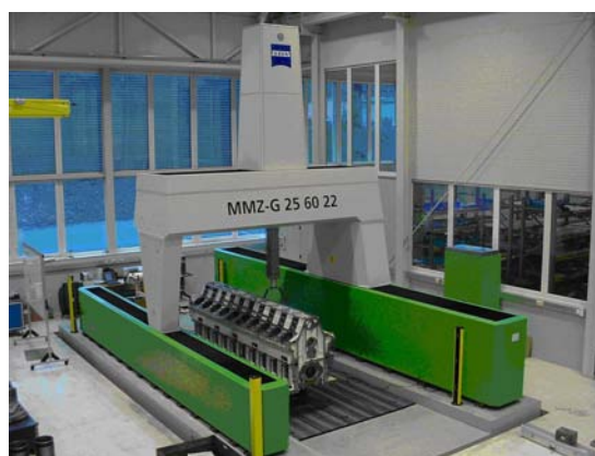
Figura 5. Máquina de medição por coordenadas (Cortesia ZEISS).
