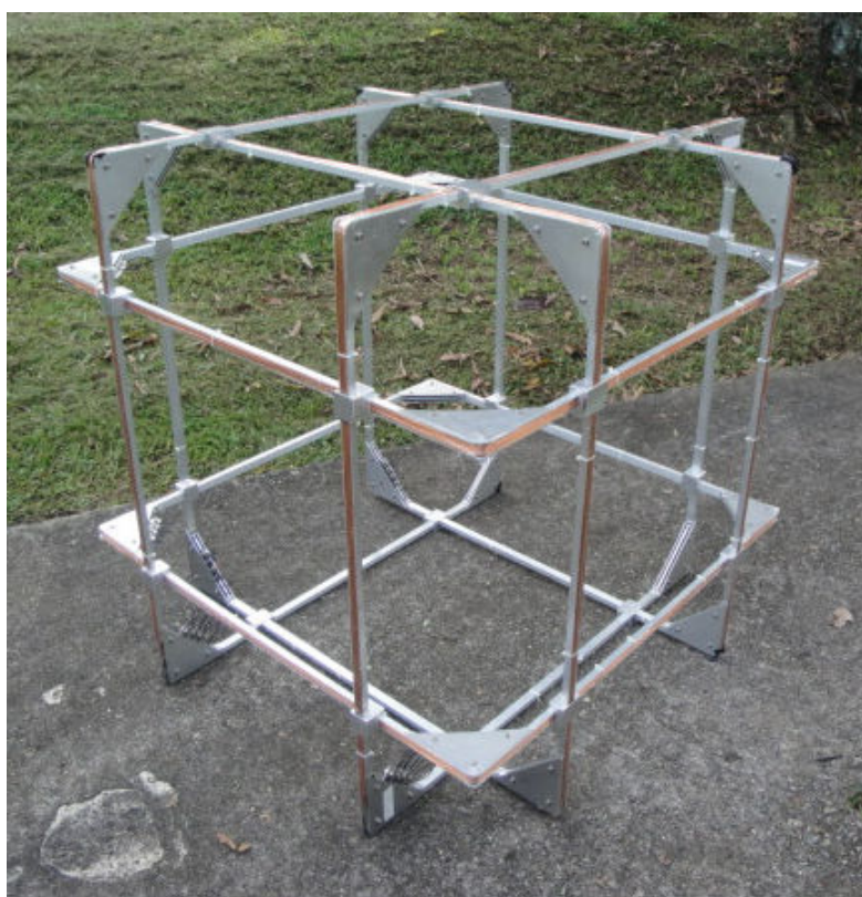
Figura 7. Montagem final do conjunto de bobinas de Helmholtz.
