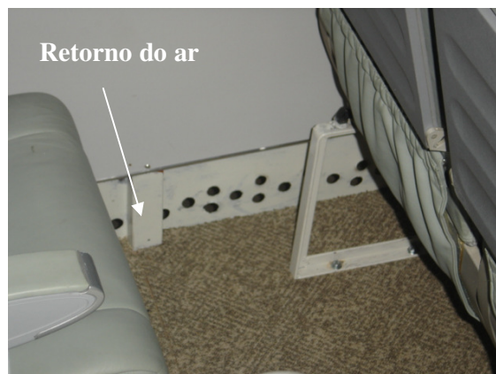
Figura 4 Detalhes do retorno do ar (Moura, 2009; Stancato, 2009)
