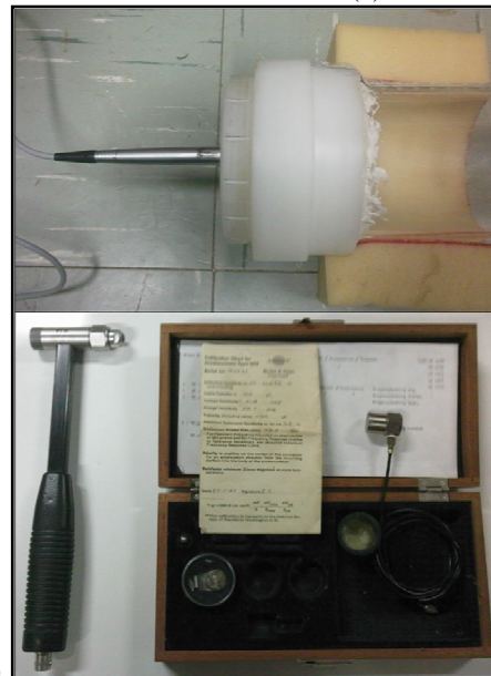
Figura 4. Descrição resumida dos ensaios realizados (a), vista geral do aparato experimental (b) – (1) Analisador de Sinais HP 35665A, (2) Amplificador de Sinais B&K Nexus e Martelo de Impacto PCB, (3) Local de Fixação de Microfone e Acelerômetro, (4) Vista Posterior do Cone de Fixação do Altofalante –, e fotos do Microfone B&K 4189-L e do Acelerômetro B&K 194537 utilizados nas medições (c).
