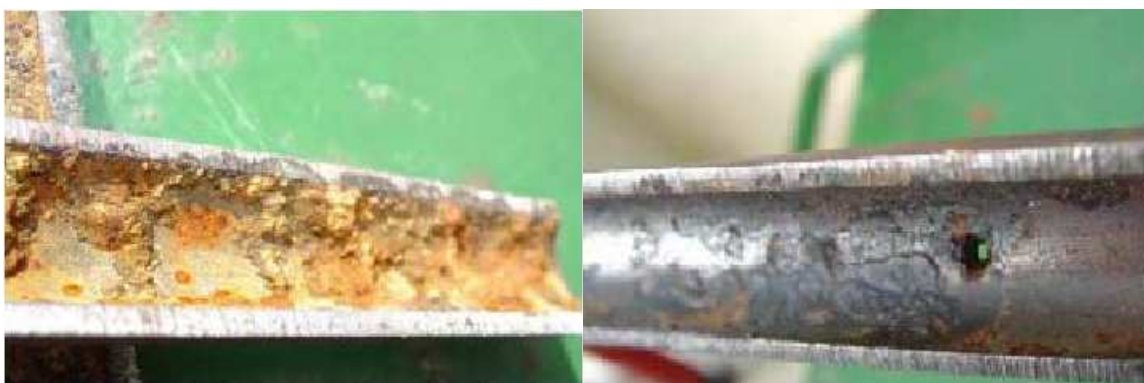
Figura 1. Efeitos da cavitação em dutos
