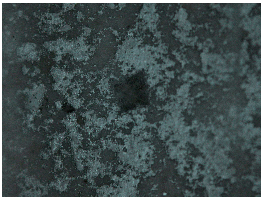
Fig. 3. Microscopia Óptica da cerâmica Ca 2 AlWO 5,5 , após o polimento, mostrando a indentação do Ensaio de Dureza Vicker's (magnificação 200x).
