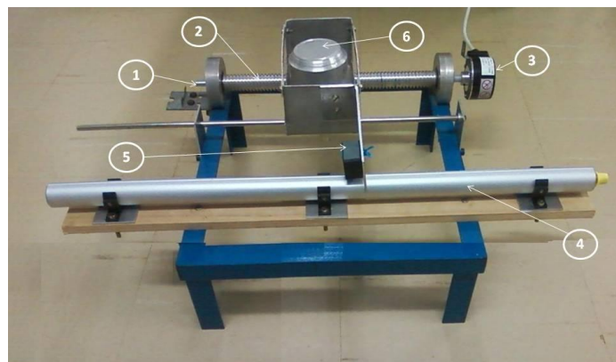
Figura 6. Bancada experimental para testes do acionamento tipo fuso
