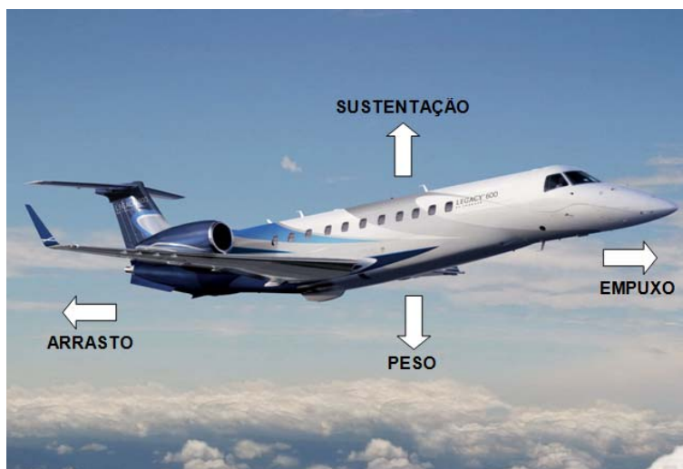
Figura 1. As quatro forças básicas que atuam em uma aeronave em voo
