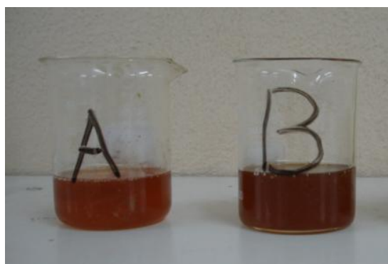
Figura 2. Pré-polímero (componente A) e isocianato (componente B)
