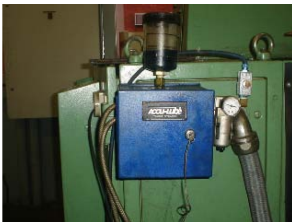
Figura 3. Sistema de bombeamento de fluido de corte pela técnica MQF
