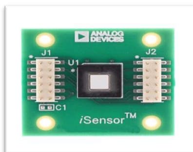
Figura 8. Placa de desenvolvimento para ADIS16209. Fonte: Manual ADIS16209
