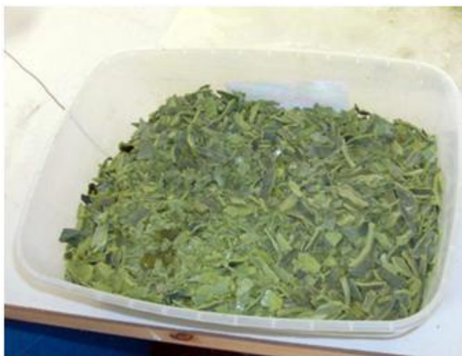
Figura 7 – Aspecto vítreo da torta provinda do processo de prensagem
