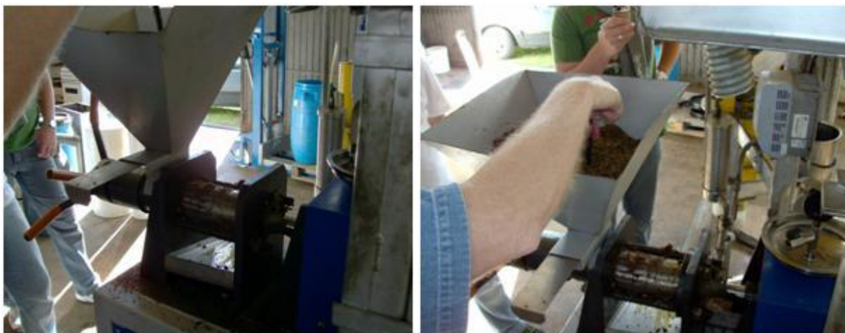
Figura 3 – Prensa extrusora do tipo helicoidal operando com grãos de canola.
