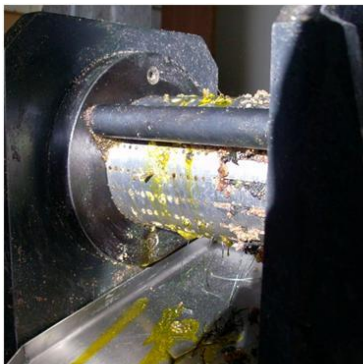
Figura 6 – Entupimento da prensa durante operação somente com microalgas
